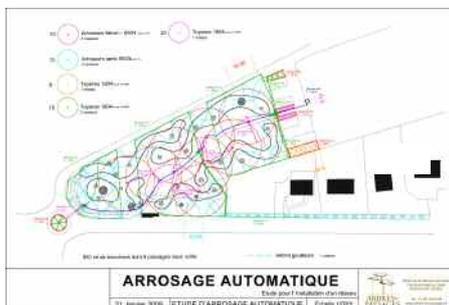
➤ **Le plan du terrain** : échelle, localisation des obstacles, zones à arroser, zones pouvant être arrosées, topographie, localisation de la source d'eau.
